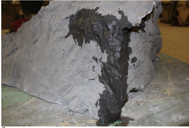
Übergänge von Felsplatte zu Felsplatte modellieren
